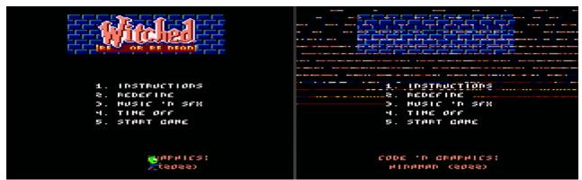
A la izquierda se muestra el buffer de video visible en los menús, y a la derecha el que no se ve. Se aprecia como el logo se ha descomprimido en el derecho y se muestra en el izquierdo. Igualmente el sprite del personaje que aparece borrando los créditos se muestra únicamente en el primer buffer de video.
